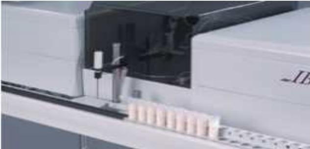
앞선 테스트의 잔류물 carry-over를 최소화 하기 위해 테스트 할 샘플을 교반해서 끌어냅니다. 각각의 샘플 후에 세척용액으로 피펫의 안팎을 깨끗이 세척해 주는 세척대가 장착되어 있습니다. Carry-over는 일반적으로 0.25% 정도로 ISO 16140 기준을 철저히 준수합니다. (<<1%)
